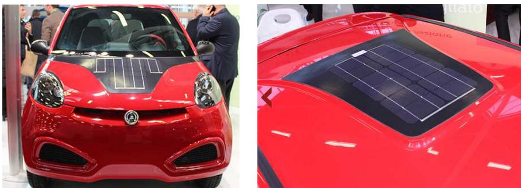
Fig. 6.7 – Foto della i.Car0, particolare anteriore e del tetto munito di pannelli fotovoltaici.
